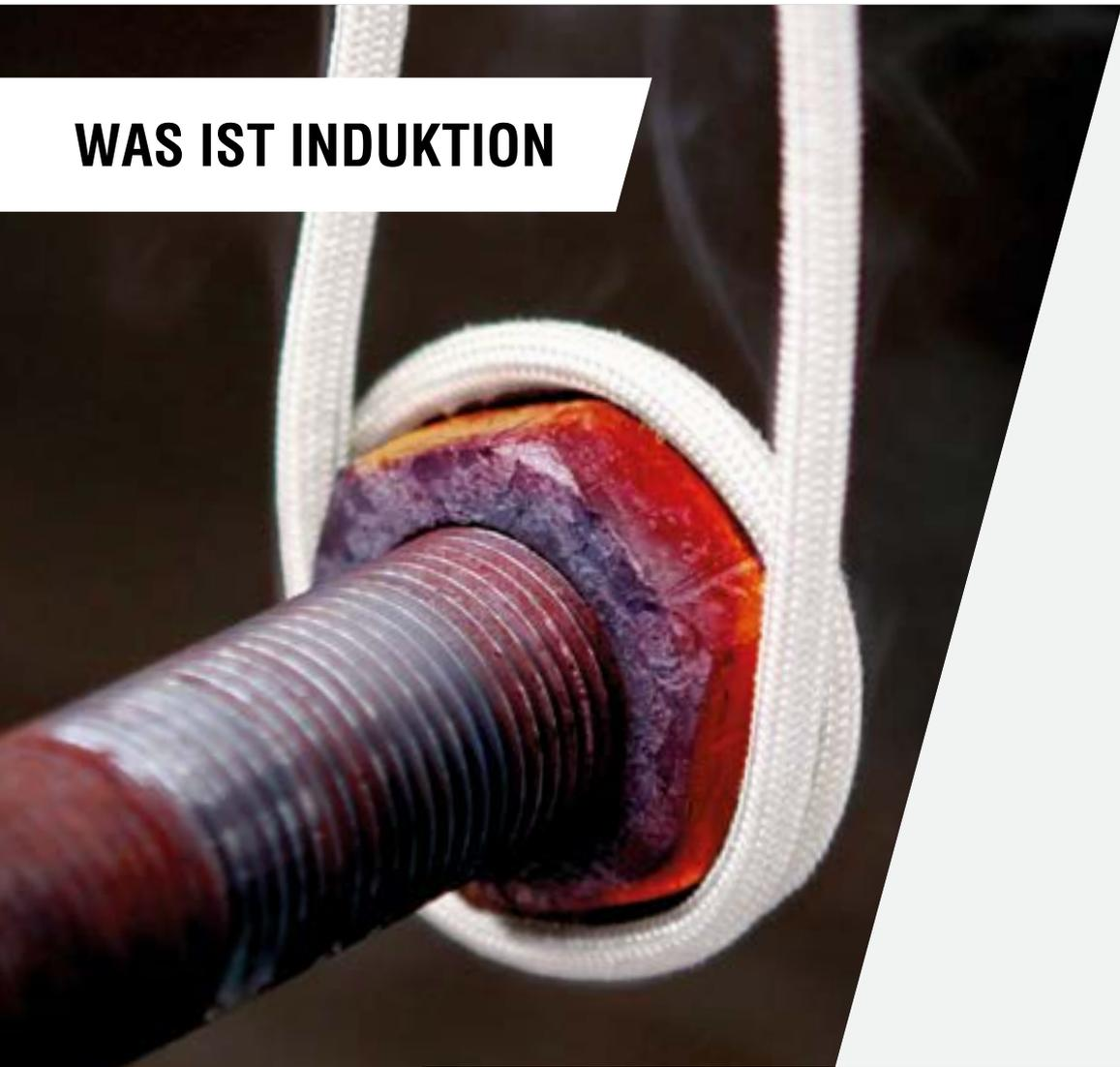
**INDUKTIONSERWÄRMUNG BIETET EINE EFFIZIENTE METHODE ZUM SCHNELLEN, PRÄZISEN ERHITZEN VON INSBESONDERE EISENHALTIGEN METALLEN UND ZUR DURCHFÜHRUNG VON RICHTARBEITEN AN VERZOGENEN KAROSSERIE- UND CHASSISTEILEN.**
