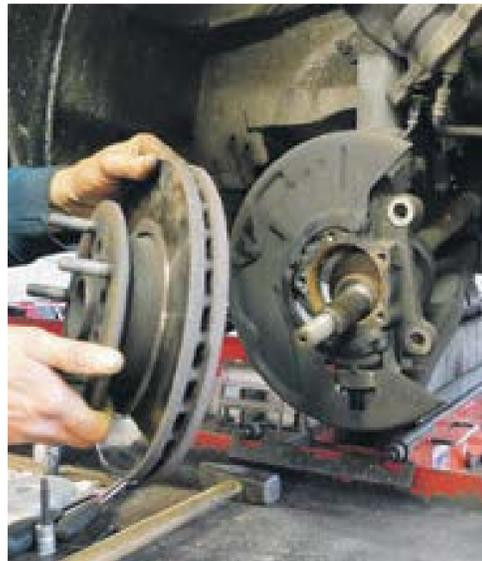
Trennen der Bremsscheibe von Lager-Naben-Einheit
