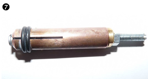
4-schlitzige Kupferbolzenaufnahme für M4 Schweißbolzen (Ø 4 mm)
