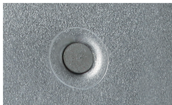
RESULTAAT VAN HET AANBRENGEN VAN SELF-PIERCING PONSNAGELS
