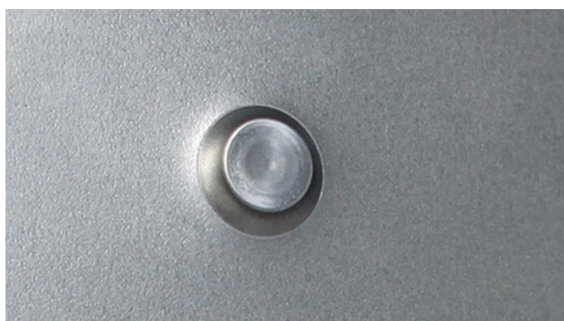
RESULTAAT VAN HET AANBRENGEN VAN SELF-PIERCING PONSNAGELS
