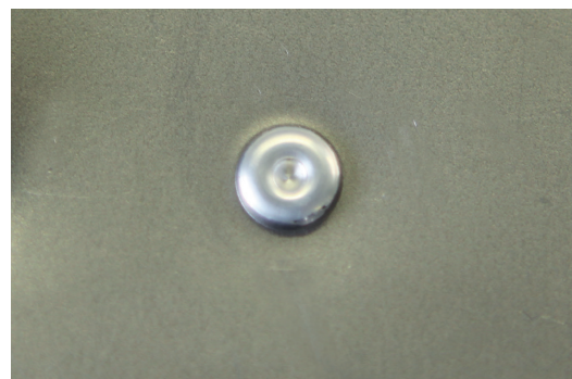
RESULTAAT VAN HET AANBRENGEN VAN FLOW-FORM RIVETS
