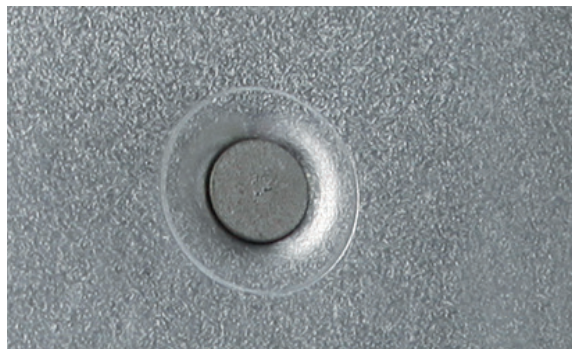
RISULTATO DELLA POSA DI UN RIVETTO AUTO-PERFORANTE
