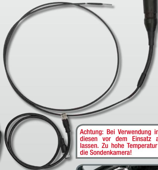
**Achtung:** Bei Verwendung im Motor, diesen vor dem Einsatz abkühlen lassen. Zu hohe Temperatur zerstört die Sondenkamera!
