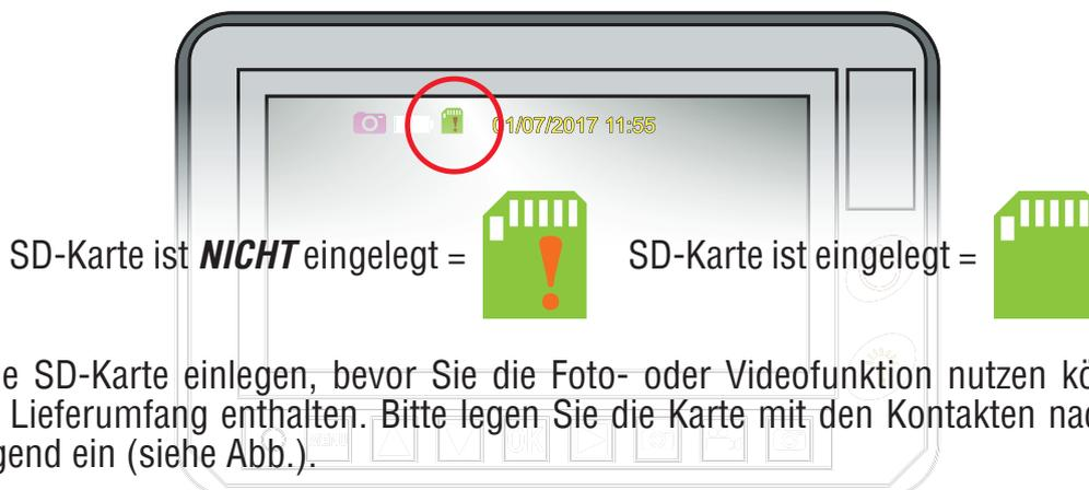
Sie müssen eine SD-Karte einlegen, bevor Sie die Foto- oder Videofunktion nutzen können. Eine 8 GB SD-Karte ist im Lieferumfang enthalten. Bitte legen Sie die Karte mit den Kontakten nach oben und zum Monitor hin zeigend ein (siehe Abb.).
