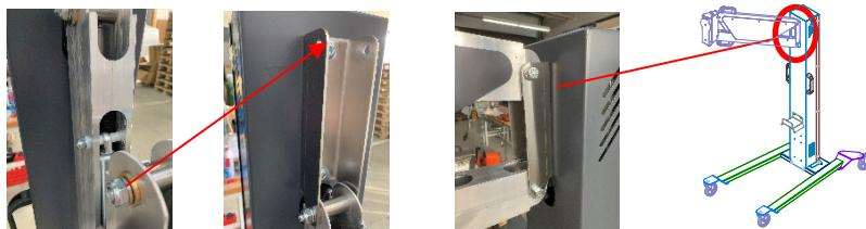
V. Montieren Sie die 2 Kassetten auf der Kassettenhalterung. Verwenden Sie die inneren Löcher!
