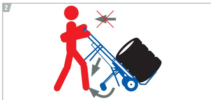
Der Reifen-/Räderstapel kann nun schnell und einfach zum Einsatzort verfahren werden. Nach Erreichen des Einsatzortes, durch Druck auf das Drehgestell, den Transportwagen mit Reifen-/Räderstapel in waagerechte Position (Bereitstellungsposition) bringen.
