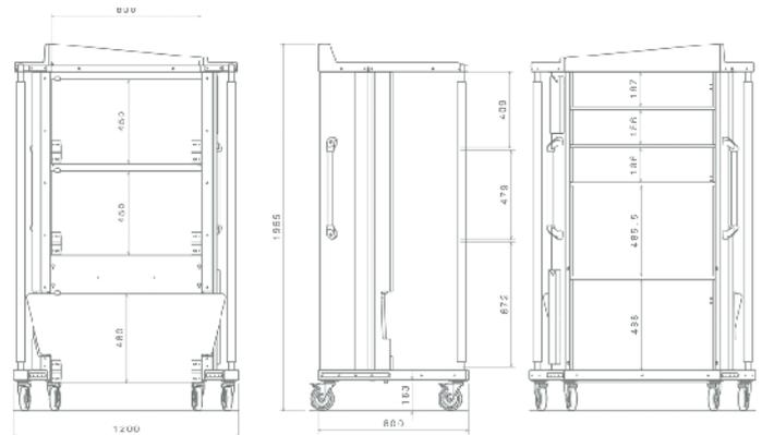
Fachböden: 15 mm Multiplex mit Gummierung
