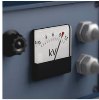
Die Stückprüfung bei 10.000 Volt gemäß IEC 60900 garantiert sicheres Arbeiten unter Spannung bis 1.000 Volt.
