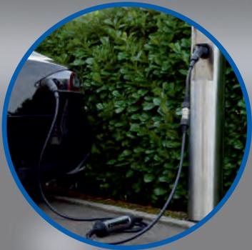
Typ-2-Kabel: Mit dem netzseitigen Typ-2-Adapter benötigen Sie nur noch ein einziges Kabel an Bord.
